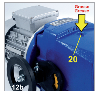
12b) Introdurre 0.19 kg (*) di grasso sintetico SHELL RETINAX EPX2 dal tappo 20
