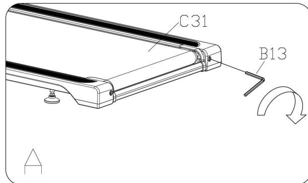
Si la **Banda de Caminadora (n.º C31)** se mueve hacia la izquierda, gire los pernos de ajuste del lado izquierdo una vuelta de  $\frac{1}{4}$  *hacia la derecha*, luego gire el perno de ajuste del lado derecho una vuelta de  $\frac{1}{4}$  *hacia la izquierda*. Si la **Banda de Caminadora (n.º C31)** no se mueve, repita este paso hasta que se centre. Consulte la Figura B.
