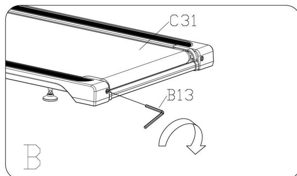
Con el tiempo, la **Banda de Caminadora (n.º C31)** se aflojará. Para ajustar la banda, gire los pernos de ajuste de los lados izquierdo y derecho una vuelta completa hacia la derecha, luego compruebe la tensión de la faja. Continúe este proceso hasta que la faja tenga la tensión correcta. Asegúrese de ajustar ambos lados por igual para asegurar la alineación correcta de la faja. Consulte la Figura C.
