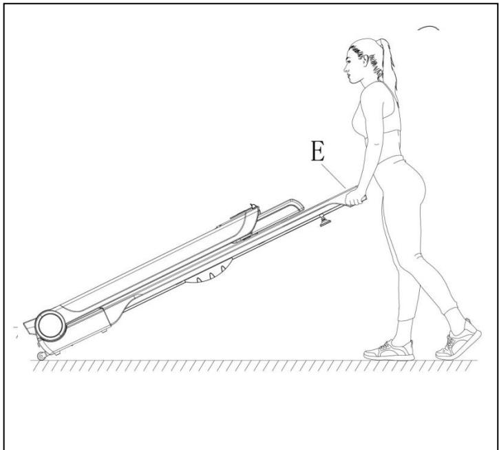
Para transportar, sostenga la caminadora en la posición E e incline hasta que las ruedas de transporte puedan moverse suavemente.
