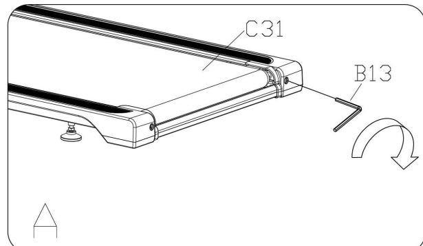
Si la **Bandé de Course (N° C31)** se déporte vers la gauche, tourner les boulons de réglage du côté gauche d' $\frac{1}{4}$  de tour dans le *sens horaire*, puis tourner celui de droite d' $\frac{1}{4}$  de tour dans le *sens antihoraire*. Si la bande ne bouge pas, répéter l'opération jusqu'à ce qu'elle soit centrée. Se reporter à la Figure B.
