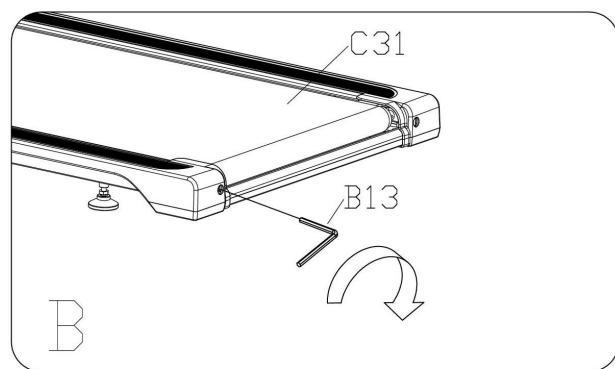
Avec le temps, la **Bandé de Course (N° C31)** va se détendre. Pour tendre la bande, tourner les boulons de réglage de gauche et de droite d'un tour complet dans le *sens horaire*, vérifier la tension de la bande. Poursuivre ce procédé jusqu'à ce que la bande soit à la tension souhaitée. Veiller à régler les deux côtés de façon identique pour assurer le bon alignement de la **Bandé de Course (N° C31)**. Se reporter à la Figure C.
