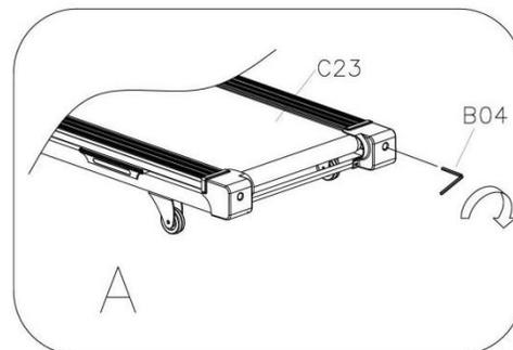
Si la **Banda De Carrera (n.º C23)** se mueve hacia la izquierda, gire los pernos de ajuste  $\frac{1}{4}$  de vuelta en el sentido de las agujas del reloj y, a continuación, gire el perno de ajuste derecho  $\frac{1}{4}$  de vuelta en el sentido contrario a las agujas del reloj. Si la **Banda De Carrera (n.º C23)** no se mueve, repita este paso hasta que se centre. Consulte la figura B.
