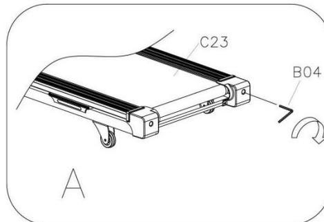
Si la **Bande De Course (n° C23)** se déplace vers la gauche, tournez les boulons de réglage de  $\frac{1}{4}$  de tour dans le sens des aiguilles d'une montre, puis tournez le boulon de réglage droit de  $\frac{1}{4}$  de tour dans le sens inverse des aiguilles d'une montre. Si la **Bande De Course (n° C23)** ne bouge pas, répétez cette étape jusqu'à ce qu'elle se centre. Reportez-vous à la figure B.
