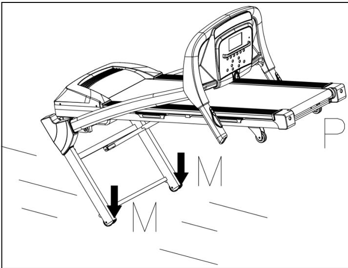
Para el transporte, mantenga la cinta de correr en la posición "P" e inclínela hasta que las "M" de la rueda de transporte puedan moverse por el suelo.
