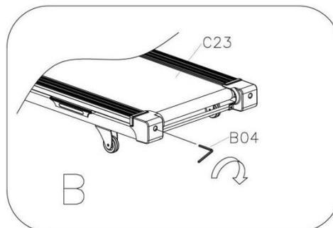
Avec le temps, la **Bande De Course (n° C23)** va se détendre. Pour tendre la **Bande De Course (n° C23)**, tourner les boulons de réglage de gauche et de droite d'un tour complet dans le sens *horaire*, vérifier la tension de la **Bande De Course (n° C23)**. Poursuivre ce procédé jusqu'à ce que la **Bande De Course (n° C23)** soit à la tension souhaitée. Veiller à régler les deux côtés de façon identique pour assurer le bon alignement de la bande. Se reporter à la figure C.
