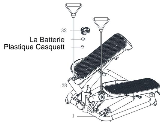
1. Retirer l'Ordinateur (N° 32) du Cadre Principal (N° 1), puis débrancher le câble de raccordement du Capteur (N° 28) de l'Ordinateur (N° 32).
