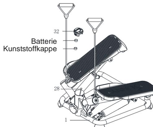
1. Entfernen Sie den **Computer (Nr. 32)** vom **Hauptrahmen (Nr. 1)** und trennen Sie den Verbindungsdraht des **Sensor (Nr. 28)** vom **Computer (Nr. 32)**.
