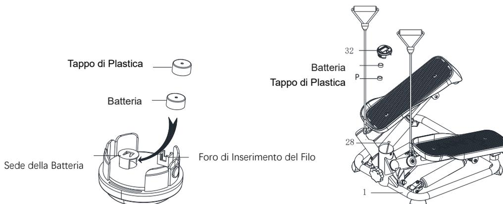
1. Rimuovere il **Computer (n. 32)** dal **Telaio Principale (n. 1)** e scollegare il cavo di collegamento del **Sensore (n. 28)** dal **Computer (n. 32)**.
