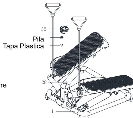
1. Retire la **Computadora (n.º 32)** del **Estructura Principal (n.º 1)** y desconecte el cable de enlace del **Sensor (n.º 28)** de la **Computadora (n.º 32)**.
