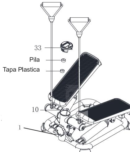
1. Retire la **Computadora** (n.º 33) del **Estructura Principal** (n.º 1) y desconecte el cable de enlace del **Sensor** (n.º 10) de la **Computadora** (n.º 33).
