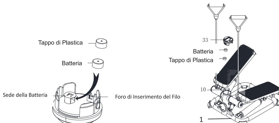
1. Rimuovere il **Computer** (n. 33) dal **Telaio Principale** (n. 1) e scollegare il cavo di collegamento del **Sensore** (n. 10) dal **Computer** (n. 33).
