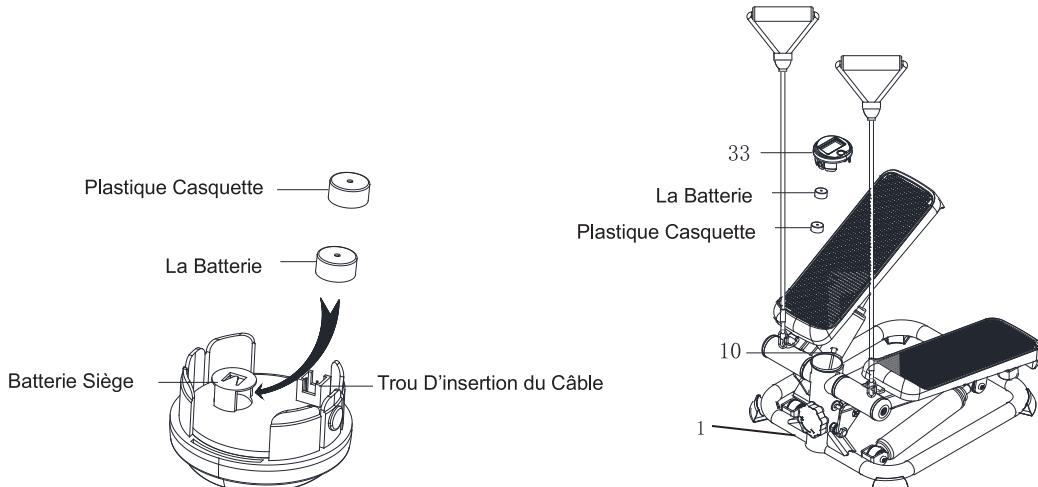
1. Retirer l'**Ordinateur (N° 33)** du **Cadre Principal (N° 1)**, puis débrancher le câble de raccordement du **Capteur (N° 10)** de l'**Ordinateur (N° 33)**.
