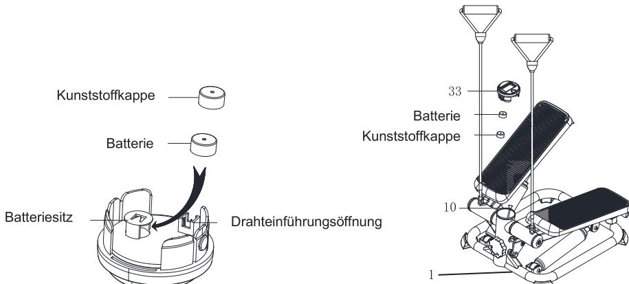
1. Entfernen Sie den **Computer** (Nr. 33) vom **Hauptrahmen** (Nr. 1) und trennen Sie den Verbindungsdrat des **Sensor** (Nr. 10) vom **Computer** (Nr. 33).
