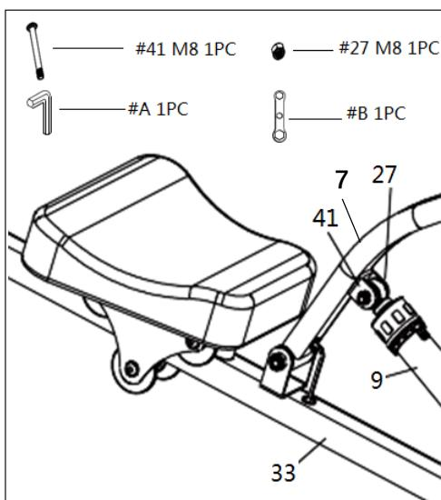
**Attenzione:** Il **Cilindro Idraulico** (n. 9) può generare un calore eccessivo dopo lunghi periodi di utilizzo, rendendolo insicuro al tatto. Lasciare raffreddare il **Cilindro Idraulico** (n. 9) prima di spostare il vogatore.
