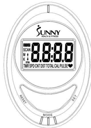
**ALARM:** Die Funktionen Zeit, Distanz und Kalorie können auf Countdown eingestellt werden, wenn einer der obigen Werte auf Null geht, alarmiert der Zähler für 10 Sekunden. Drücken Sie MODE, um die Funktion auszuwählen, und drücken Sie dann SET, um den Wert einzustellen.
