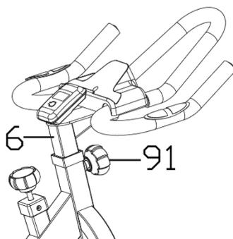
Il est important que le guidon et la selle soient tous deux réglés à la hauteur qui convient à votre corps. Pour régler la hauteur du guidon, desserrer le **Bouton à Cliquet (N° 91)** et le tirer vers l'extérieur, puis faire coulisser la **Tige de Guidon (N° 6)** vers le haut ou vers le bas jusqu'à la position souhaitée. Une fois le réglage accompli, réinsérer et serrer le **Bouton à Cliquet (N° 91)** pour immobiliser la **Tige de Guidon (N° 6)**.
