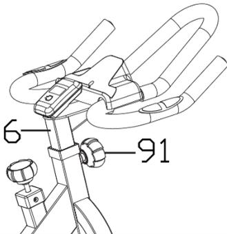
Es ist wichtig, dass die Lenkstange und der Sitz auf die richtige Höhe im Verhältnis zu Ihrem Körper eingestellt sind. Um die Höhe der Lenkstange einzustellen, lösen und ziehen Sie den **Pop-Pin-Knopf (Nr. 91)** nach außen. Schieben Sie dann die **Lenkerstütze (Nr. 6)** nach oben oder unten auf die gewünschte Höhe. Setzen Sie nach dem Einstellen den **Pop-Pin-Knopf (Nr. 91)** wieder ein und ziehen ihn fest um die **Lenkerstütze (Nr. 6)** in der Position zu fixieren.
