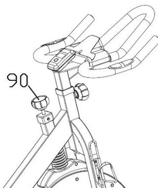
Il est possible de régler le niveau de tension du vélo en tournant le **Bouton de Tension (N° 90)**. Pour augmenter le niveau de résistance, tourner le bouton dans le sens *horaire*. Pour réduire le niveau de résistance, tourner le bouton dans le sens *antihoraire*.
