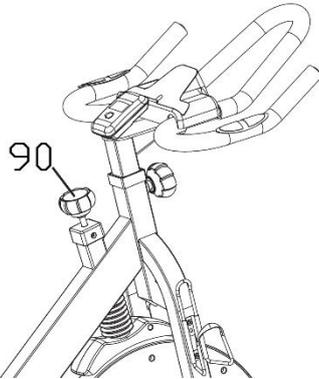
Sie können das Spannungsniveau des Fahrrads durch Drehen des **Spannknots (Nr. 90)** einstellen. Um den Widerstandsgrad zu erhöhen, drehen Sie den Knauf *im Uhrzeigersinn*. Um den Widerstandsgrad zu verringern, drehen Sie den Knauf *gegen den Uhrzeigersinn*.
