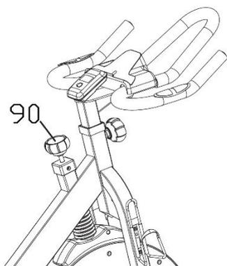
Puede ajustar el nivel de tensión de la bicicleta al girar la **Perilla de Tensión (n.º 90)**. Para aumentar el nivel de resistencia, gire la perilla *hacia la derecha*. Para reducir el nivel de resistencia, gire la perilla *hacia la izquierda*.
