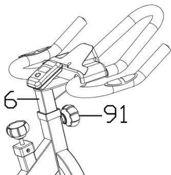
Es importante que tanto el manubrio como el asiento estén fijados a la altura correcta de su cuerpo. Para ajustar la altura del manubrio, afloje y tire de la **Perilla del Resorte de Regulación (n.º 91)** hacia afuera; luego, deslice el **Barral del Manubrio (n.º 6)** hacia arriba o hacia abajo hasta la altura deseada. Una vez ajustado, vuelva a insertar y apretar la **Perilla del Resorte de Regulación (n.º 91)** para fijar el **Barral del Manubrio (n.º 6)** en su lugar.
