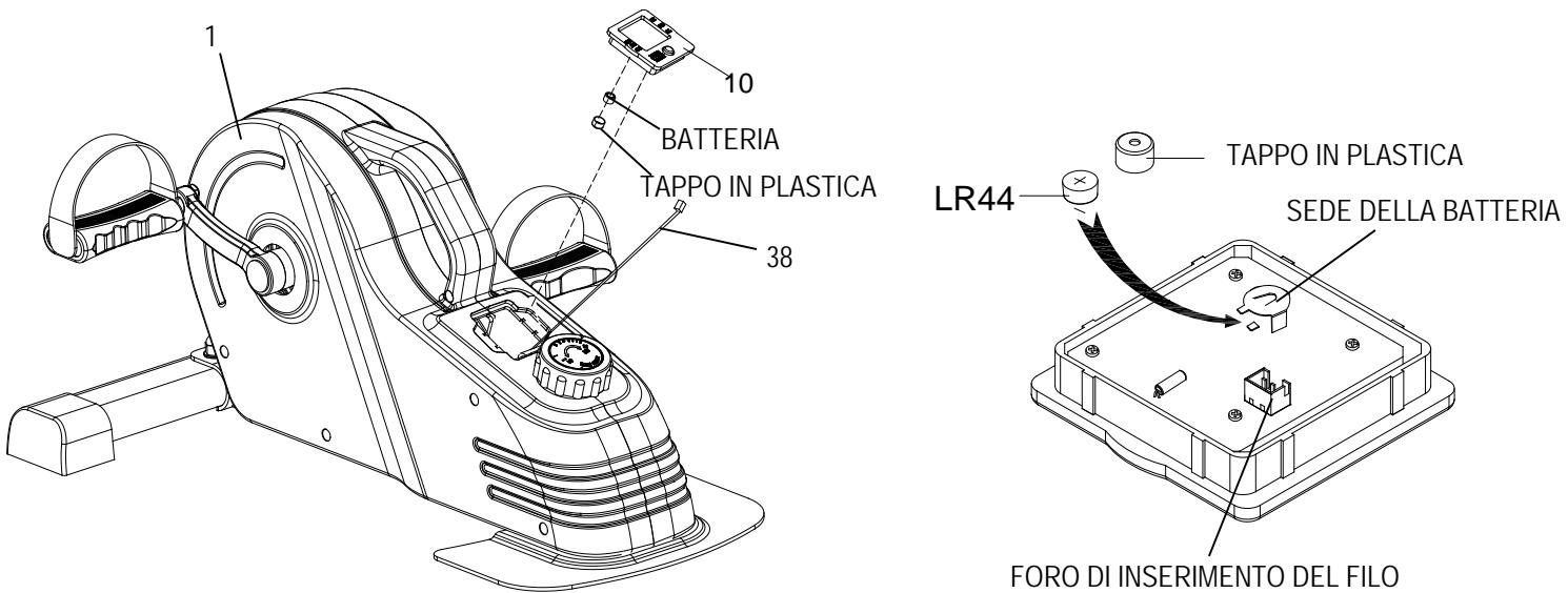
Rimuovere il **Contatore (n. 10)** dal **Telaio Principale (n. 1)**. Quindi scollegare il filo di collegamento dell'**induttore (n. 38)** con il **Contatore (n. 10)**.
