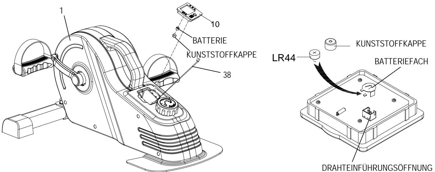
Entfernen Sie das **Messgerät (Nr. 10)** vom **Hauptrahmen (Nr. 1)**. Trennen Sie dann das Verbindungskabel des **Induktor (Nr. 38)** vom **Messgerät (Nr. 10)**.
