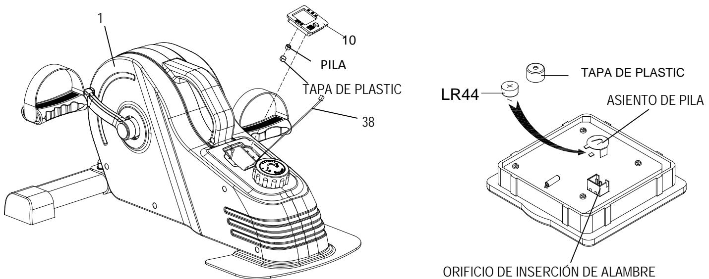
Retire la **Computadora** (n. ° 10) de la **Estructura Principal** (n. ° 1). Luego desconecte el cable de enlace del **Inductor** (n. ° 38) con la **Computadora** (n. ° 10).
