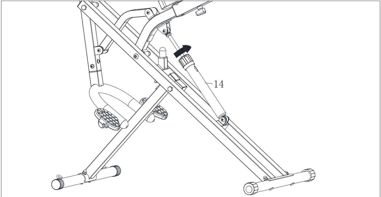
**NOTA:** Non regolare la resistenza del **Cilindro Idraulico (n. 14)** durante il funzionamento per evitare lesioni e danni all'istruttore per esercizi di squat.
