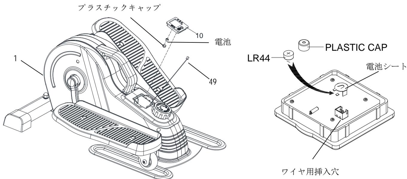
1. メーター (No. 10) をメインフレーム (No. 1) から取り外します。次に、インダクター (No. 49) とメーター (No. 10) のリンクワイヤを外します。
