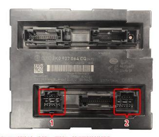
拆BCM2插头时,先拆1,再拆2,然后再拆其他插头。 装BCM2插头时,先装2,再装1,然后装其他插头。
