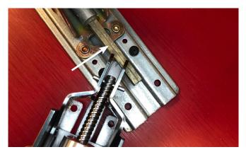
9. STRAIGHTEN KIT, DEPRESS BACK ACTIVATING BRACKET, & GENTLY PULL BACK ON THE MOTOR TO SLIDE MOUNTING BRACKET UNDERNEATH BASERAIL.
