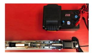
13. SLIDE HOUSING BACK ONTO BASERAIL & PUSH PAD. MAKE SURE THE BASERAIL & THE BLACK PUSH PAD GUIDES ARE IN THE CORRECT CHANNEL.
