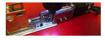
12 RE-INSTALL PUSH PAD ONTO BASERAIL.
