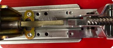
**9** STRAIGHTEN KIT & PULL BACK TO SLIDE MOUNTING BRACKET <u>Underneath</u> Baserail.
