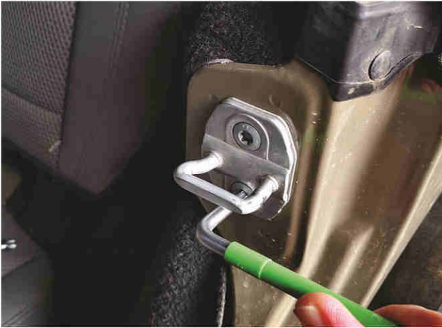
2 remove rear door hooks
