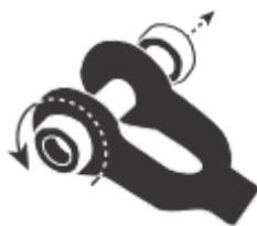
Plaats de twee uiteinden van de lus in de beugel van de kabelspanners en plaats de moeren terug en draai de bouten vast.
