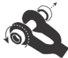
Stecken Sie die beiden Enden der Schleife in die Wantenspannerbacke und befestigen Sie die Muttern an den Schrauben in der Backe.
