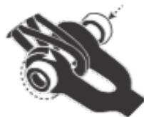
Montieren Sie nun das Hauptseil auf einer der beiden Seiten am Wantenspanner (Ort, der am wenigsten erreichbar ist.) Der Grund dafür ist, dass Sie das Kabel am anderen Ort festziehen müssen - natürlich bevorzugen Sie den Ort, der am niedrigsten am Boden oder am einfachsten zu erreichen ist.)
