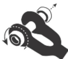
Insérez les deux extrémités de la boucle dans la mâchoire du tendeur et fixez les écrous aux boulons de la mâchoire.
