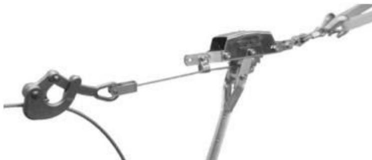
Schritt 1: Wickeln Sie die Nylon Bandschlinge um Ihren Anker (oben oder unten, je nachdem, welches Ende am besten zugänglich ist), und befestigen Sie die Endschlaufen an den Haken auf der Rückseite von den Handseilzug. Es macht die Sache einfacher, wenn Sie es ein wenig oberhalb der Stelle, an der Sie das Hauptteils verankern wollen, einwickeln.
