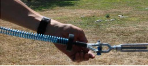
**Étape 4-** Fixez l'autre extrémité de la tyrolienne autour du 2ème arbre selon les instructions d'installation avec les attaches en U. Placez le chariot sur la ligne avant de terminer l'installation
