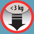
Les pointes Labcon pour pipettes LTS™ sont fabriquées à partir de résines flexibles spéciales. Pour faciliter l'éjection, appliquez une force inférieure à 3 kg lors de l'assemblage. Ne pas exercer de force excessive en plaçant la pointe sur le corps de pipette.
