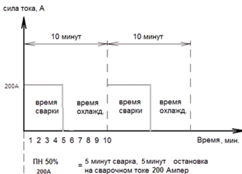
График продолжительности полного цикла работы сварочного генератора
