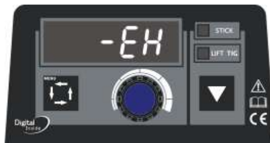
Рис 11: Дисплей при перегреве
