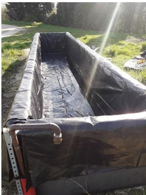
Ainsi, avant le début de la nouvelle saison, l'utilisateur pourra soulever le couvercle de la cuve, retirer la bâche avec le résidu sec, et envoyer le tout chez ADIVALOR. Une nouvelle bâche pourra alors être introduite dans la cuve.
