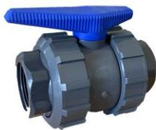
Vanne femelle 1'1/4 PVC pour cuve à visser à boisseau sphérique. Sièges en HDPE (polyéthylène)- Joints toriques en EPDM Cet accessoire est spécialement conçu pour les cuves utilisées pour la récupération, le stockage et la consommation d'eau
