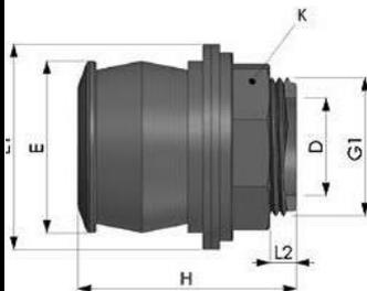
E1 : 62 mm E : 52 mm H : 65 mm D : 29.5mm
