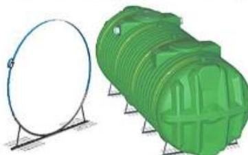
Dispositif d'ancrage simplifiant l'installation de la cuve. Il est constitué d'un châssis assemblé à la cuve en usine. Celui-ci intègre du treillis soudé à noyer dans le béton. Il est relié à la cuve par une ceinture + système de tendeurs.
