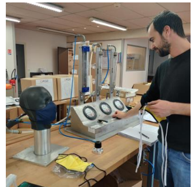
Banc de test résistance inspiration et expiration OUVRY
