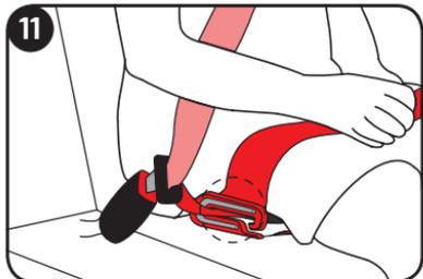
Introduzca la sección ventral del cinturón de seguridad del vehículo a través de las guías del cinturón de color rojo situadas a cada lado del asiento elevador.
