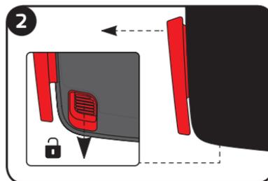
Para desbloquear las guías del cinturón ventral, deslice el botón de desbloqueo de la guía del cinturón ventral hacia adelante. Para bloquear las guías, suelte el botón de desbloqueo de la guía del cinturón ventral.
