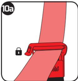
Para colocar la guía del cinturón del hombro, fije la guía del cinturón del hombro a la sección diagonal del cinturón de seguridad del vehículo, abriendo el gancho e insertando el cinturón. A continuación, cierre el gancho.
