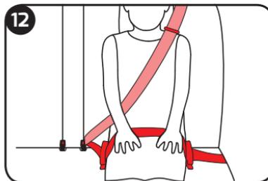
Asegúrese de que la sección ventral del cinturón de seguridad del vehículo haya pasado a través de las ranuras del cinturón ventral en los dos lados del asiento elevador.
