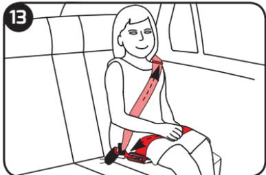
Enderece el cinturón del asiento si estuviera retorcido y ténselo tirando de la sección ventral y, a continuación, de la sección diagonal del cinturón de seguridad para adultos. Asegúrese de que la sección ventral esté situada sobre el regazo del niño y apoyada en su pelvis.
