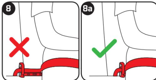
Coloque a su hijo sentado con la espalda erguida en el asiento elevador y, si fuera necesario, deslice las guías del cinturón ventral hasta situarlas en la posición más próxima al muslo del niño, pero sin llegar a tocarlo. Tire de las guías del cinturón ventral para comprobar que estén bloqueadas.
