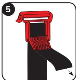
5 Para acortar o alargar la guía del cinturón del hombro, tire de la correa para colocarla en la posición que desee.
