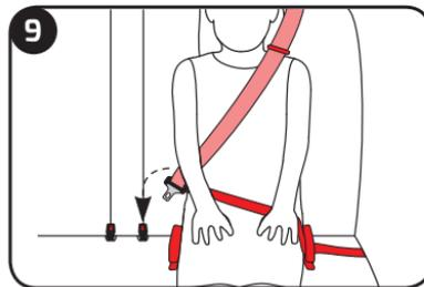
Coloque el cinturón de seguridad del vehículo a través de la parte delantera del cuerpo de su hijo. Deslice la sección ventral del cinturón de seguridad del vehículo a través de las dos guías del cinturón ventral introduciendo la lengüeta del cinturón en la hebilla del vehículo.
