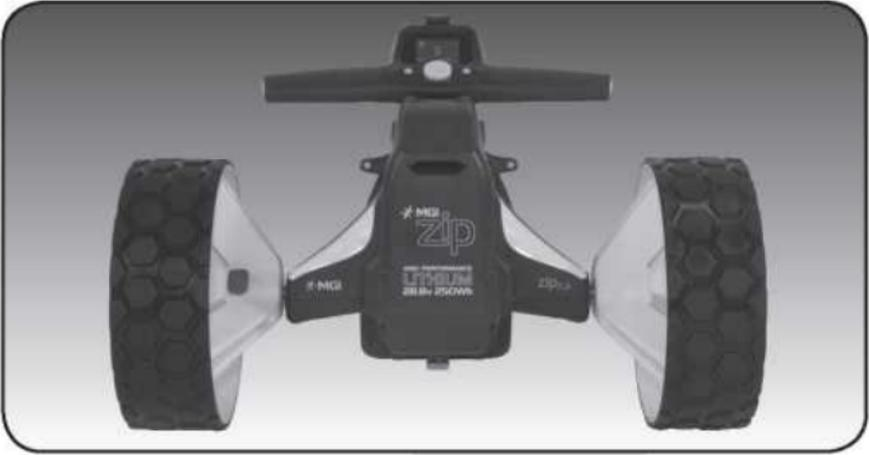
Na roda, prima o botão de libertação cinzento existente no cubo da roda. Coloque a roda no eixo. Irá reparar que é necessário fazer corresponder a ranhura fêmea interior do eixo à ranhura macho da roda. Assim que as rodas estiverem em posição, basta que liberte o botão. Irá ouvir um "clique" quando a roda estiver devidamente fixa. Para verificar se a roda está na devida posição, puxe a roda. Caso se encontre na devida posição, não irá deslizar para fora. Repita o processo para a outra roda.
