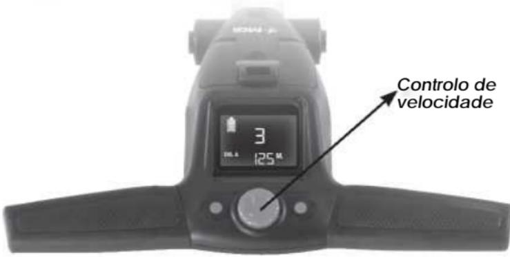
Ligue a bateria (consultar secção 4.2). Para seleccionar a velocidade pretendida, rode o botão de controlo de velocidade conforme ilustrado no diagrama acima. Rodar o botão de controlo de velocidade para a direita irá aumentar a velocidade, enquanto que rodá-lo para a esquerda irá reduzir a velocidade. A definição de velocidade seleccionada é apresentada no centro do ecrã a cores. Para que o buggy arranque com esta velocidade, toque no topo do botão de controlo de velocidade.
