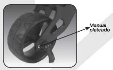
SUBA el tornillo manual plateado del lado izquierdo o a derecho para enderezar el carrito más hacia la IZQUIERDA. SUBA el tornillo manual plateado del lado izquierdo o a derecho para enderezar el carrito más hacia la IZQUIERDA. Puede girar ambos tornillos simultáneamente para conseguir la alineación que desee.
