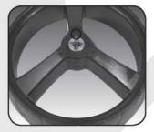
Paso 2 Pulse el botón de liberación situado en el cubo de la rueda. Coloque la rueda en el eje. Deberá hacer coincidir la ranura hembra interior con el eje y la ranura macho de la rueda. Una vez que está colocada en su posición, solo tiene que soltar el botón. Escuchará un "clic" cuando la rueda esté bien asegurada. Para comprobar que la rueda está bien colocada, tire de ella. Si está bien colocada, no se deslizará hacia afuera. Repita el proceso con la otra rueda.
