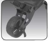
Paso 2: Hay dos tornillos manuales plateados situados en cada lado de la rueda delantera. Al ajustar estos tornillos, conseguirá enderezar la alineación rectificando el carrito para que se mueva más hacia la izquierda o más hacia la derecha.
