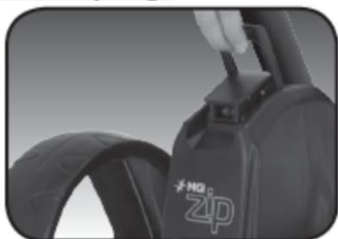
**Étape 1 :** Débranchez la batterie. Elle peut être laissée sur le buggy ou retirée du buggy.
