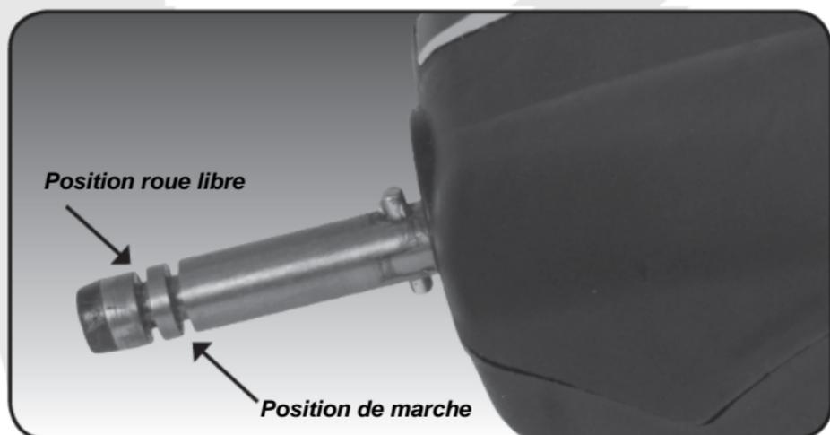
***i. Position de marche-** Verrouiller la roue dans la rainure la plus proche de la base de la batterie. Pour ce faire, veuillez appuyer sur le bouton de déblocage gris du moyeu, poussez la roue en direction de l'axe aussi loin que possible. Pour tester la position de marche, essayez de faire rouler les roues en marche arrière. Si vous avez une sensation de résistance, alors la roue est en position de marche et prête à l'emploi. Répétez la procédure pour les deux roues.*
