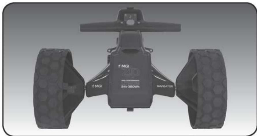
Sur la roue, appuyez sur le bouton de déblocage gris du moyeu. Placez la roue sur l'axe. Vous devez insérer la rainure femelle interne de l'axe dans la rainure mâle de la roue. Après l'avoir positionné, relâchez simplement le bouton. Vous entendrez un « clic » lorsque la roue est correctement fixée. Pour vérifier que la roue est dans la bonne position, tirez sur la roue. Si elle est dans la bonne position, elle ne glissera pas. Répétez cette étape pour l'autre roue.
