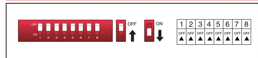
A NOTER : Merci de bien débrancher puis rebrancher l'alimentation du boîtier après un réglage DIP
