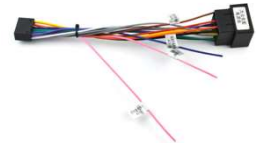
Câble d'alimentation principal
