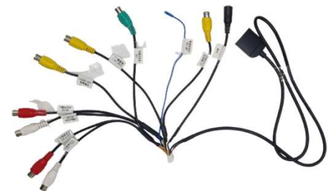
Câbles accessoires, sortie micro et lecteur carte SIM 4G
