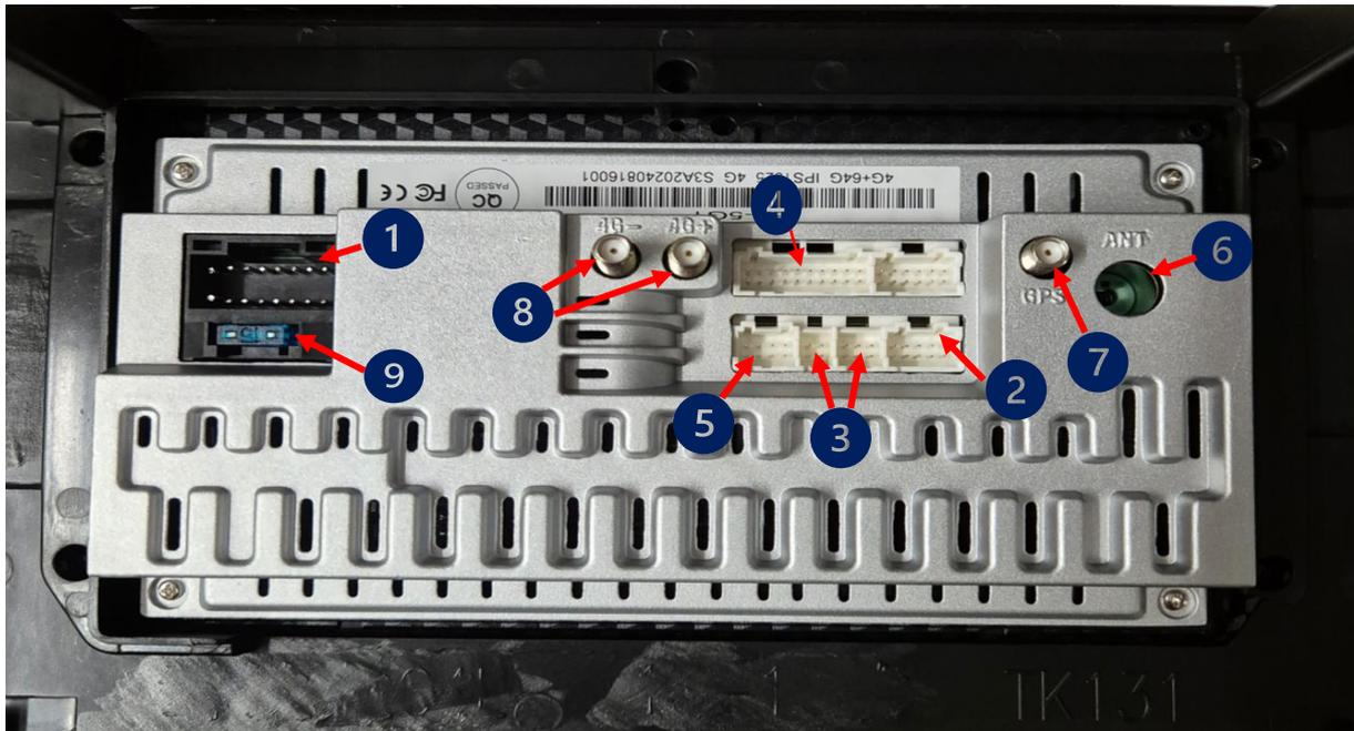
1. **Câble ISO** : Branchement principal de l'autoradio, à connecter à l'un des câbles d'alimentation fournis, correspondant au système du véhicule.
