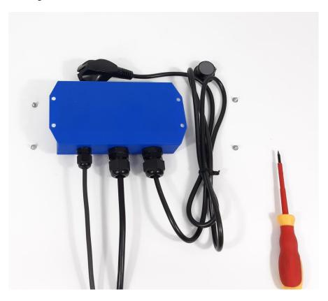
So sieht dann die fertige Multimeter – Poti-Box aus. Zum Schluss können Sie die Schutzfolie des Multimeters entfernen.
