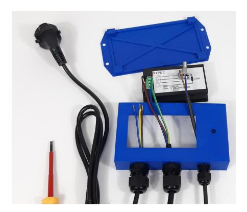
Um das Multimeter anschließen zu können müssen alle Schrauben erst einmal gelöst werden. Anschließend wird an der oberen und unteren Klemme die Input Leitung des LED-Treibers angeschlossen. An den mittleren Klemmen wird die Zuleitung befestigt. Nun können Sie auch das Poti festschrauben. Das Poti wird and die DIM-Leitung des Treibers angeschlossen. Die Erdungsadern
