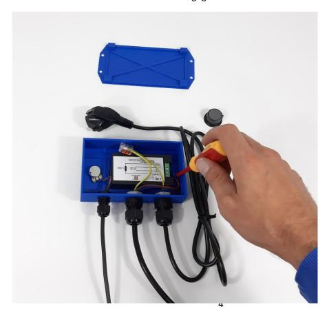
Als nächstes müssen die Verschraubungen festgezogen werden, so dass sich die Kabel nicht mehr herausziehen lassen. Dann können Sie die Rückseite einsetzen und an der Seite mit den 4 Schrauben befestigen.
