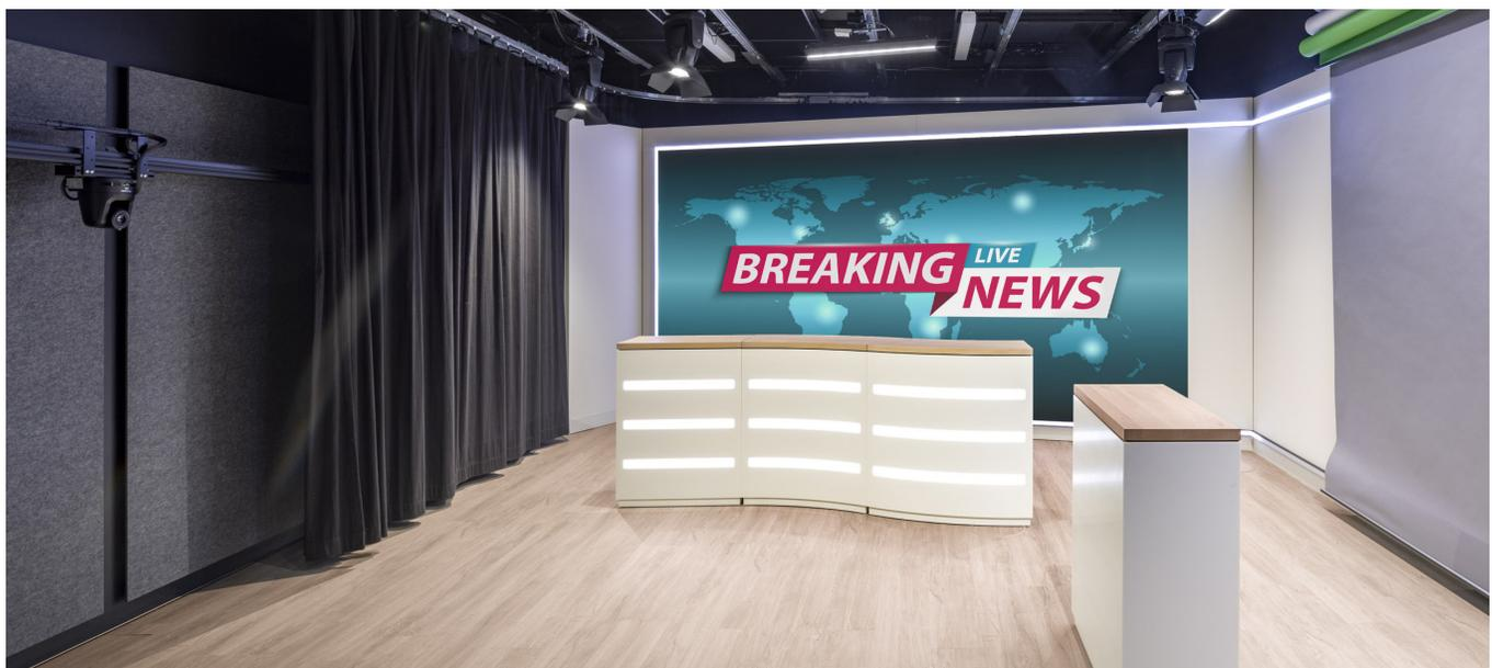
In Bezug auf die dvLED-Videowand, wandte sich Mevis.tv an den AV-Technologiepionier Peerless-AV. Aufgrund von Trägern und Beleuchtungsschienen kam eine an der Decke montierte Struktur nicht in Frage. Peerless-AV schlug eine freistehende Halterung vor, die am Boden befestigt wurde, wobei die nivellierbaren Füße mit dem Beton-Doppelboden verschraubt wurden. Es war viel Planung erforderlich, um sicherzustellen, dass das Montagesystem stabil genug ist, um das hohe Gewicht der dvLED-Wand zu tragen.
