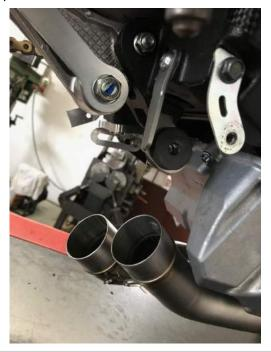
6.Installare il bivio 2in1 fissandolo con la vite M8 e il bullone in dotazione alla staffa telaio precedentemente montata
