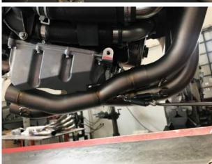
5. Fissare la staffa al telaio con la vite a brugola 5. Fix the holder to the frame with the button head cap screw
