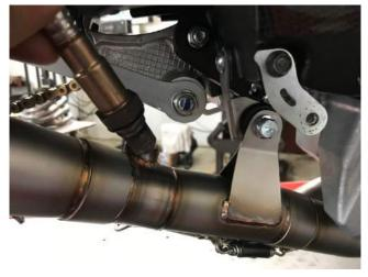
8.Installare la staffa alla pedana usando le viti originali, poi montare il raccordo al silenziatore 8.Mount the holder to rearset with the original screws, then mount the connecting tube to silencer
