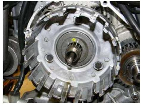
POSIZIONARE LE 6 SFERE, POSIZIONARE IL TAMBURO E PROVARE A RUOTARE PER VERIFICARE IL MOVIMENTO
