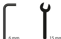
6 mm Inbusschlüssel oder 15 mm Maulschlüssel
