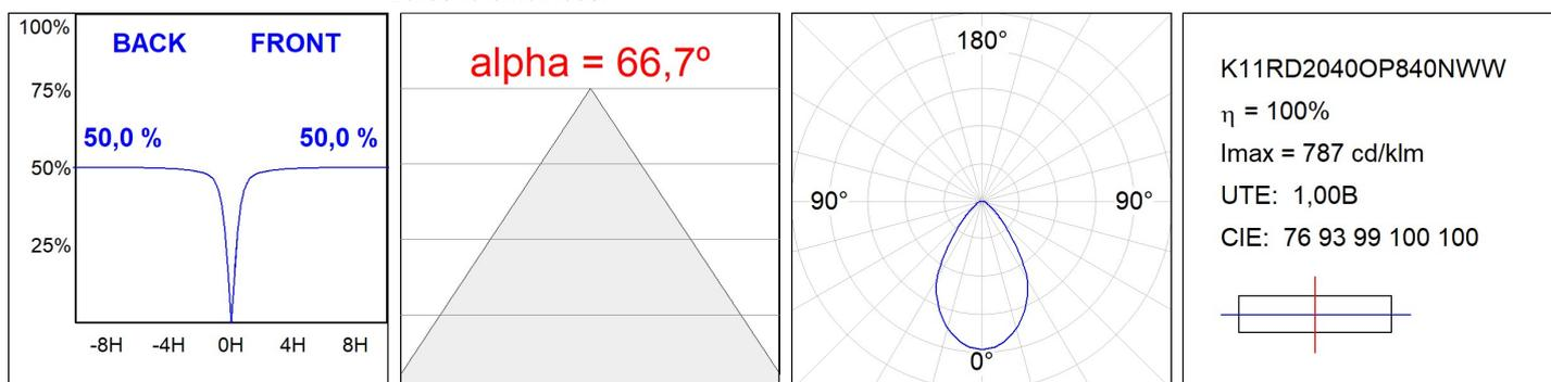
**Flujo de salida:** 1.541 lm      **Eficacia:** 115 lm/w
