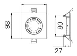
**Instalación:** Crear perforación 80 x 80 mm y cablear el luminario, subir los resortes e introducir el luminario.
