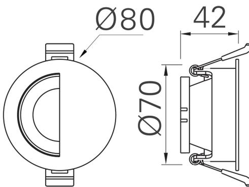
**Instalación:** Crear perforación circular de 70 mm y cablear el luminario, subir los resortes e introducir el luminario.
