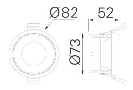
**Instalación:** Crear perforación circularde 75 mm y cablear el luminario, subir los resortes e introducir el luminario.
