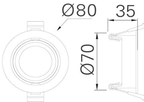
**Instalación:** Crear perforación circular de 70 mm y cablear el luminario, subir los resortes e introducir el luminario.
