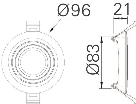
**Instalación:** Crear perforación circular de 85 mm y cablear el luminario, subir los resortes e introducir el luminario.
