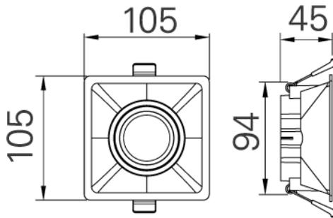
**Instalación:** Crear perforación 95 x 95 mm y cablear el luminario, subir los resortes e introducir el luminario.
