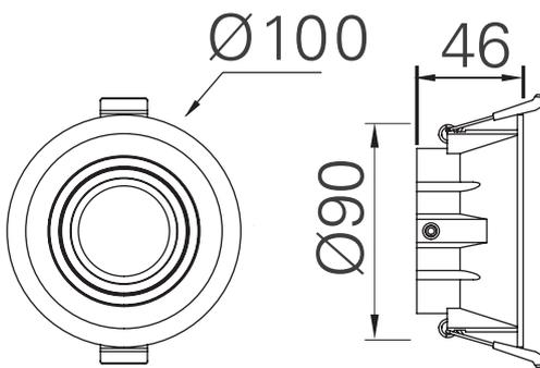
**Instalación:** Crear perforación circular de 92 mm y cablear el luminario, subir los resortes e introducir el luminario.
