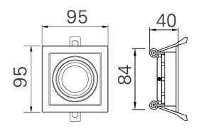
**Instalación:** Crear perforación 85 x 85 mm y cablear el luminario, subir los resortes e introducir el luminario.
