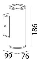
Instalación: Cablear el luminario, fijarlo con tornillos a muro y colocar la tapa con los tornillos incluidos.
