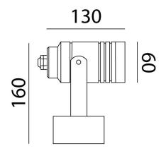
Instalación: Fijar la base del luminario a la pared, cablear y atomillar el luminario a la base.
