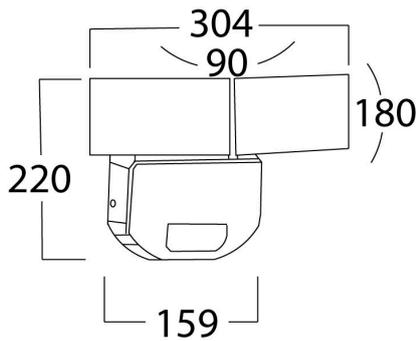
**Instalación:** Fijar la base del luminario a muro, cablear y colocar el luminario en la base con los tornillos integrados.
