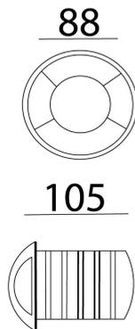
**Instalación:** Crear perforación en piso de 12 cm de profundidad y 8.5 cm de ancho, introducir la caja de empotrar, cablear e introducir el luminario a presión.
